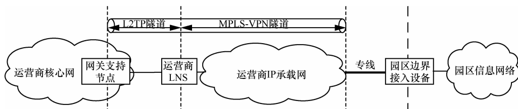
图6 L2TP+MPLS-VPN隧道示意(租用运营商LNS)
